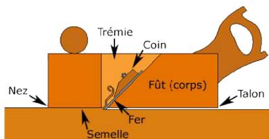
Le profondeur de la passe prise par la raboteuse correspond à l'enfoncement du fer dans le bois. Afin de garantir la stabilité de la raboteuse, le talon est situé sur un plan parallèle à celui du nez et juste en dessous.
